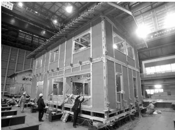
伝統構法住宅の耐震性についての実験 (E-ディフェンス 兵庫県)
