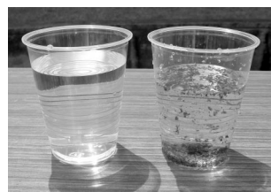
(左) トレスキューでろ過された池の水 (右) ろ過前の池の水
