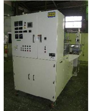
▲開発されたRTM混合注入機
