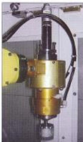
産業用ロボット向けに開発されたバリ取り・仕上用のツールホルダー。最大の特徴は、従来一つのロボットで複数のツールを使用する場合に必要なツール単位のスピンドルモーターや交換用アタッチメントは一切用いずに、ツール先端だけが自動交換可能な事。ツールのみの交換を可能にした事で、複数ツールを用いるバリ取り用ロボットシステムの大幅コストダウンと省スペース化を実現。また、ツール先端が被加工品の形状に倣う様にフローティング機構も内蔵した。このツール単体のみの交換が可能かつフローティング機構を備えたものは他に例が無い。
